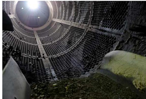
1. Après maturation, les mâchefers sont calibrés par passage dans un **trommel 0-40 mm**.
