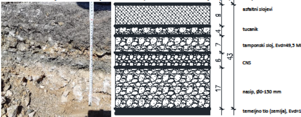
Slika 2. Istražna jama na lokaciji km 10+900 m, kolnička konstrukcija tip 1, lijevi prometni trak
