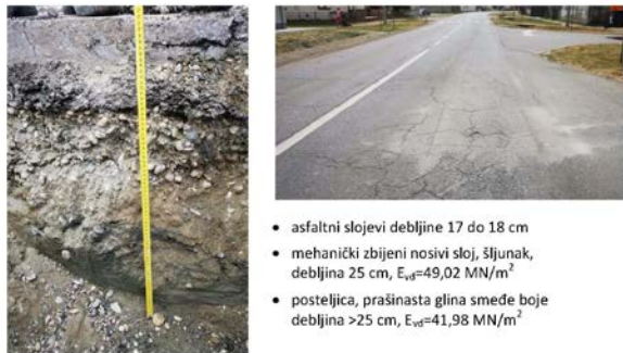
Slika 3. Istražna jama na poziciji 3, km 11 + 800 m, desno
